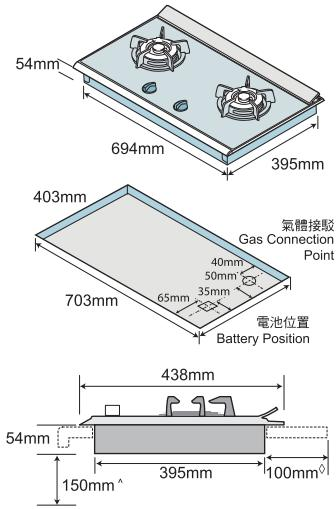
平面爐與牆身須留最少100毫米的距離
