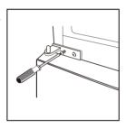
10.從上門底部擰下帶有金屬塊的右側中間止動器。然後在左側安裝左側中間止動器和金屬塊。
